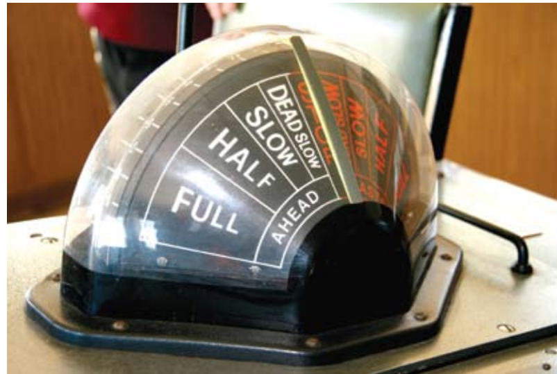
> Transmetteur d'ordres aux machines d'un navire
